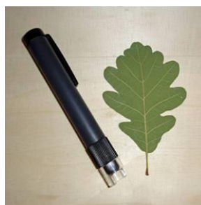
Fig. 3 Microscope de poche Eschenbach 40X
